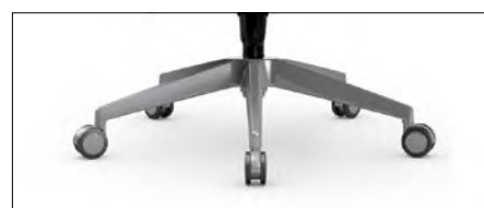
Base Star en aluminium poli. Diamètre 69 cm. 5 branches à section trapézoïdale et arêtes arrondies.
