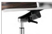
**SYNCHRO OSCILO** : mécanisme avec carcasse en aluminium poli. Mouvement d'inclinaison du dossier et rotation de l'assise selon un rapport 2:1. Inclinaison maximale de 20 degrés. 5 positions de fixation. Système anti-retour. Réglage de la tension ou dureté de l'inclinaison du dossier. Réglage de l'inclinaison et de la hauteur avec des poignées latérales.
